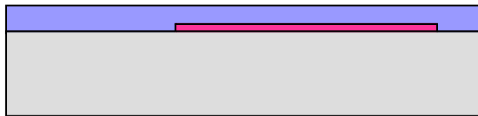
Deposit 1µm TEOS or LTO
