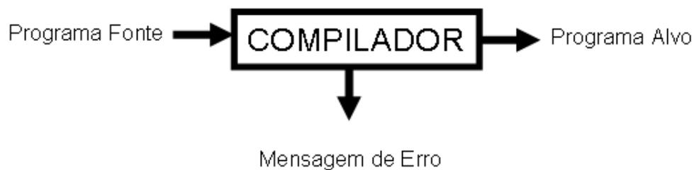
Figura 6.10: Funcionamento básico de um compilador. (AHO 1995)
